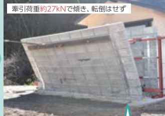
牽引荷重約27kNで傾き、転倒はせず
